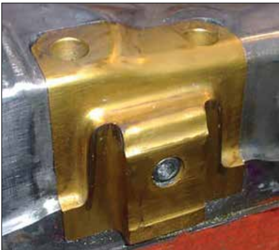
자동차 부품을 만드는 데 사용되는 고강도 강재에 대한 PVD 코팅 트리밍 금형 공구.
